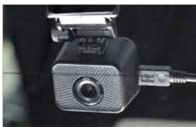
2ndカメラはリアウインドーに粘着テープを使って装着。角度調整も簡単に行える。
