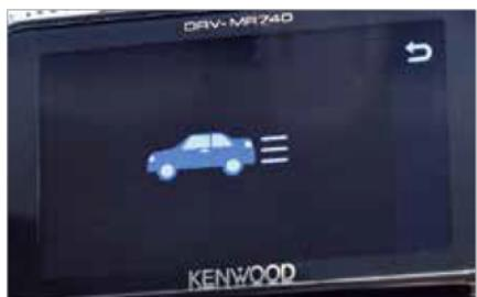
さまざまな運転支援機能を搭載。写真は前方車両の発車を検知する『発進遅れ警告』だ。
