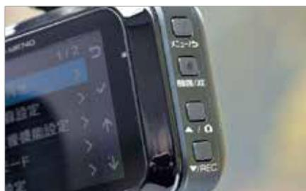
本体側面には大型の操作キーが並び、画面の右端には各キーの役割を示すアイコンを表示。
