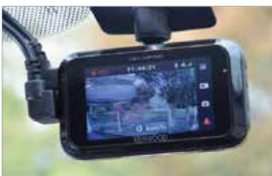
本体背面には2.7型ディスプレイを搭載。記録中の車両前後の映像を同時に確認できる。
