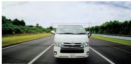
後方からの急接近車等を自動で検知してドライバーに知らせながら録画を開始するAIセンシング機能が備わる。
