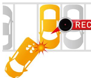
別売りの車載用電源ケーブル「CA-DR150」を使用することで、最長24時間の駐車監視録画が可能。衝撃検知と動体検知に対応しており、メインユニットで検知をした瞬間から前5秒、後5秒の駐車録画をおこなう。なお、駐車している状態と判断されるのはエンジンを切って5分後から。
