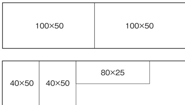
1. 車両側の板金エッジ部を保護するため、保護シート⑫を左図のようにカットします。
