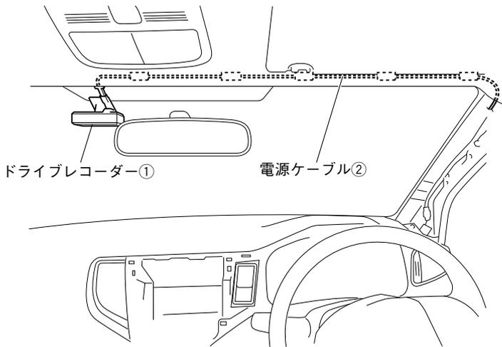
1. 電源ケーブル②をヘッドライニング内に入れ込みながら、フロントピラー部へ配線します。
