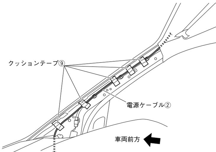
2. 電源ケーブル②をフロントピラーにクッションテープ⑨で固定しながら配線します。
