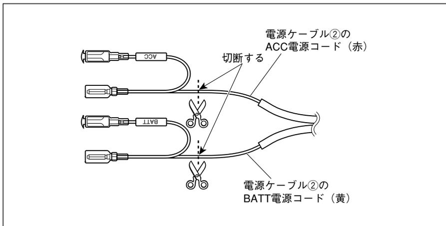
1. 電源ケーブル②のBATT電源コード（黄色コード）およびACC電源コード（赤色コード）先端のギボシ端子部を切断します。
