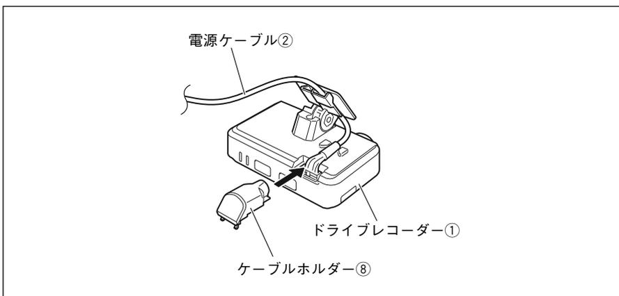
3. 電源ケーブル②をドライブレコーダー①に接続し、ケーブルホルダー⑧を取り付けます。
