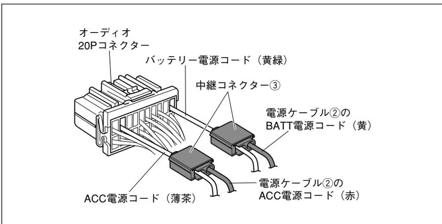
2. オーディオ20P コネクター（水色）のバッテリー電源コードに電源ケーブル②のBATT電源コード（黄色コード）を中継コネクター③で接続します。
