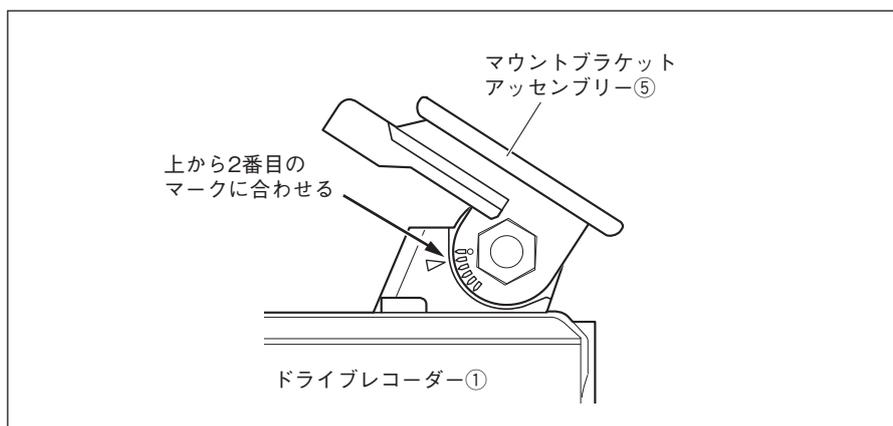
1. マウントブラケットアッセンブリー⑤をドライブレコーダー①に組み付け、左図の位置に固定します。
