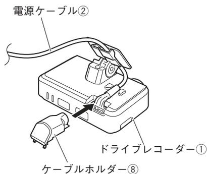
3. 電源ケーブル②をドライブレコーダー①に接続し、ケーブルホルダー⑧を取り付けます。
