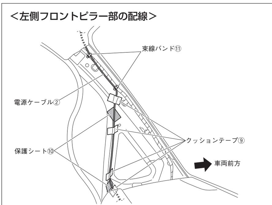
2. 電源ケーブル②をフロントピラーに束線バンド⑪およびクッションテープ⑨で固定しながら配線します。
