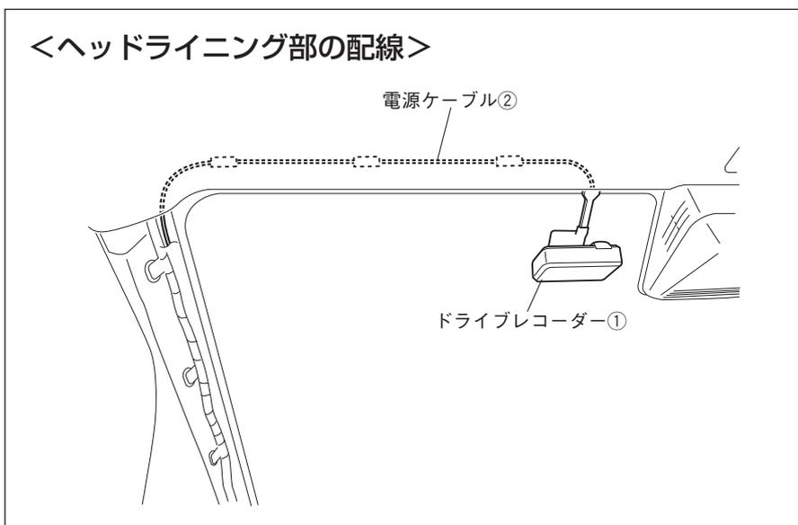
1. 電源ケーブル②をヘッドライニング内に入れ込みながら、フロントピラー部へ配線します。
