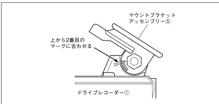
1. マウントブラケットアセンブリー⑤をドライブレコーダー①に組み付け、左図の位置に固定します。
