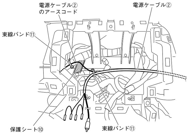
5. 結線図を参照して電源ケーブル②を接続します。
