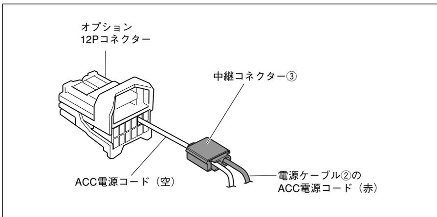
4. オプション12Pコネクター（白色）のACC電源コードに電源ケーブル②のACC電源コード（赤色コード）を中継コネクタ③で接続します。
