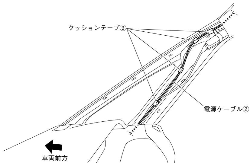
3. 電源ケーブル②をフロントピラーにクッションテープ⑨で固定しながら配線します。
