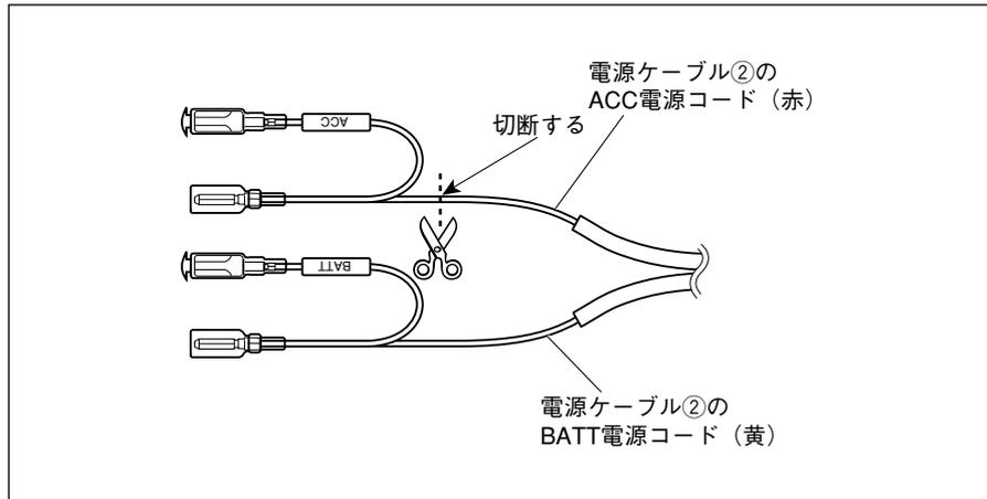
1. ACC電源コード（赤色コード）先端のギボシ端子部を切断します。
