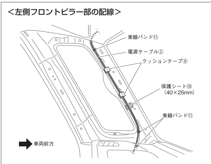
2. 電源ケーブル②をフロントピラーに束線バンド⑪およびクッションテープ⑨で固定しながら配線します。
