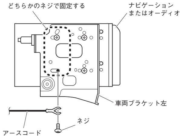
5. 電源ケーブル②のアースコードを車両ブラケット左の図の位置に固定します。
