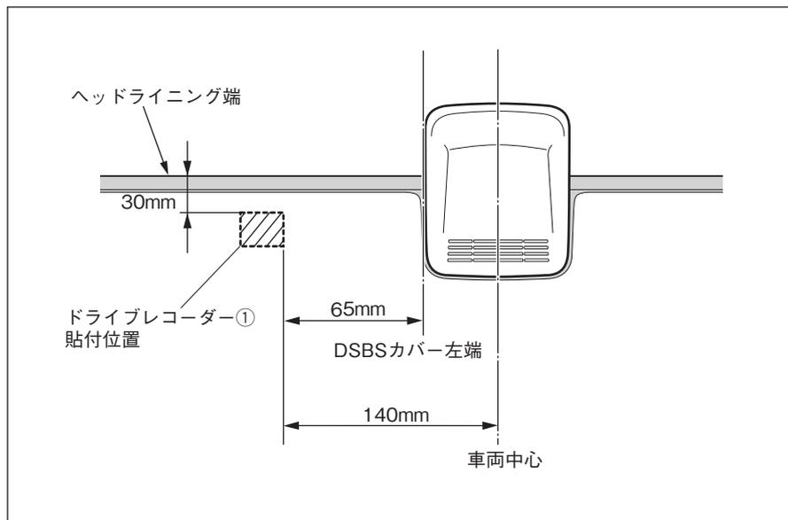
1. ドライブレコーダー①は、左図の位置に取り付けます。DSBS付き車、DSBS無し車共に、ドライブレコーダー①の取付位置は同じです。それぞれ左図の寸法にて取り付けてください。
