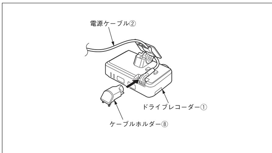
3. 電源ケーブル②をドライブレコーダー①に接続し、ケーブルホルダー⑧を取り付けます。
