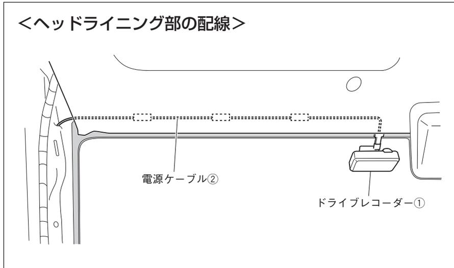
1. 電源ケーブル②をヘッドライニング内に入れ込みながら、フロントピラー部へ配線します。
