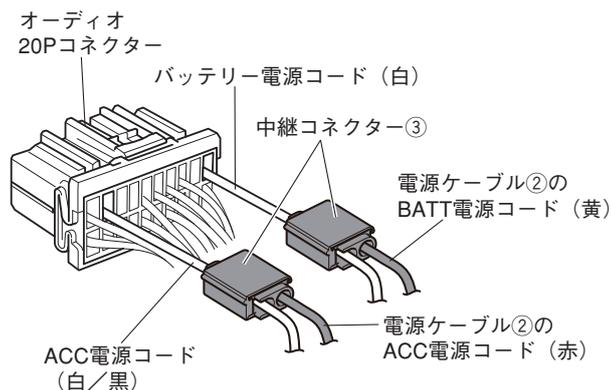
2. オーディオ20P コネクタ (水色) のバッテリー電源コードに電源ケーブル②のBATT電源コード (黄色コード) を中継コネクタ③で接続します。
