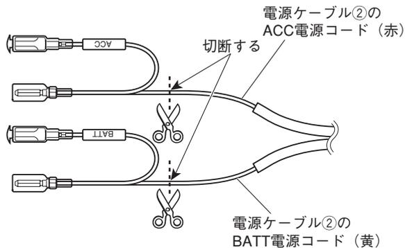
1. 電源ケーブル②のBATT電源コード (黄色コード) およびACC電源コード (赤色コード) 先端のギボシ端子部を切断します。
