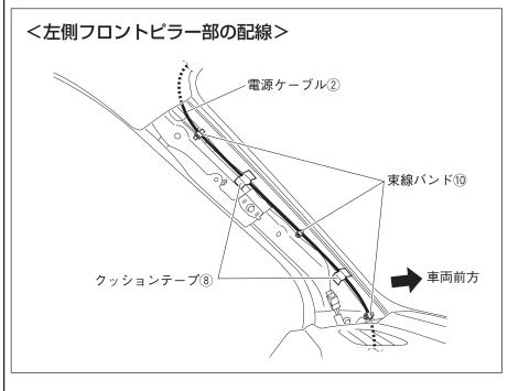
2. 電源ケーブル②をフロントピラーに 束線バンド⑩およびクッションテー プ®で固定しながら配線します。
