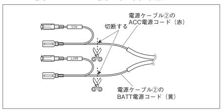
電源ケーブル②のBATT電源コード (黄色コード) およびACC電源コード (赤色コード) 先端のギボシ端子部を 切断します。
