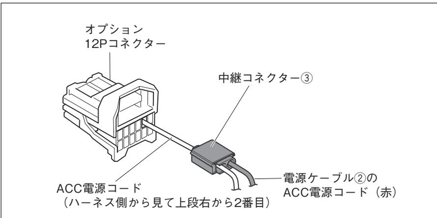
4. オプション12Pコネクター（白色）のACC電源コードに電源ケーブル②のACC電源コード（赤色コード）を中継コネクター③で接続します。
