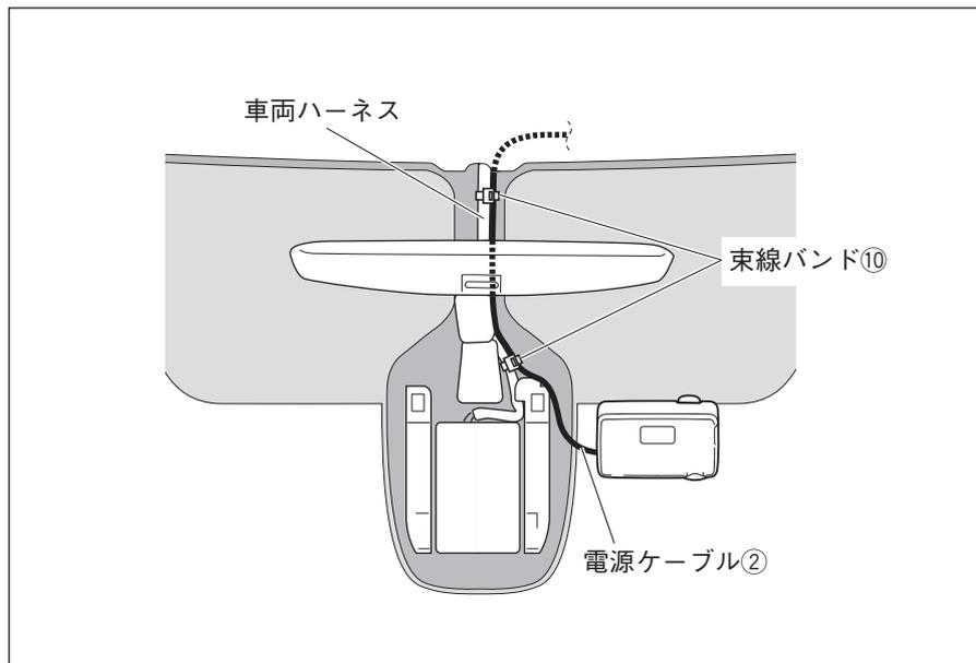
1. 電源ケーブル②を車両ハーネスに束線バンド⑩で固定しながら配線します。
