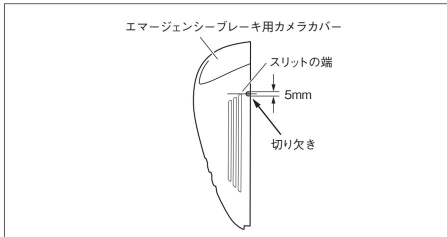
3. エマージェンシーブレーキ用カメラカバーの右側面に丸棒ヤスリ等で切り欠きを入れます。
