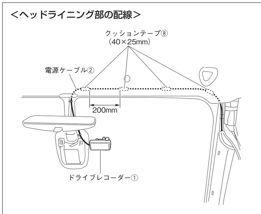
2. 電源ケーブル②をヘッドライニング内に入れ込みながら、フロントピラー部へ配線します。
