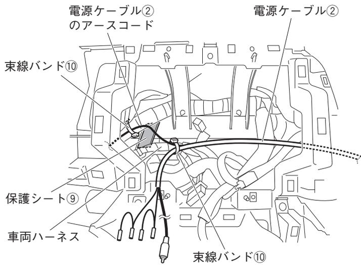
5. 結線図を参照して電源ケーブル②を接続します。
