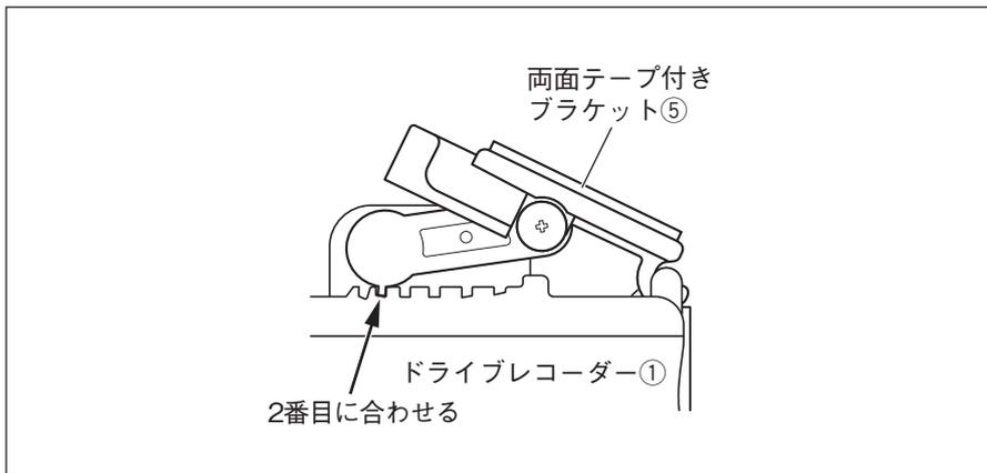
1. 両面テープ付きブラケット⑤をドライブレコーダー①に組み付け、左図の位置に固定します。
