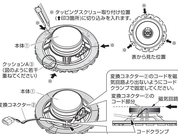
1. 本体①裏の取り付け面にクッションA③を図のように取り付け法兰ジ部の裏面の内周に沿って貼り付けます。貼りあわせ部は図のように若干重ねてください。
