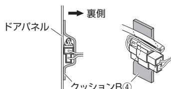
※スピーカーハーネスを固定する箇所は、スクリュー や水抜き穴等を避け、平らな面に固定してください。
