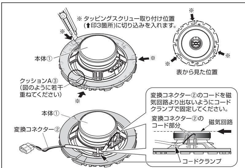
1. 本体①裏の取り付け面にクッション A ③を図のように取り付けフランジ部の裏面の内周に沿って貼り付けます。貼りあわせ部は図のように若干重ねてください。
