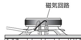
4. 図のようにブラケットのネジ穴と本体①の長丸穴を合わせ、タッピングスクリーン⑤を使って本体①をブラケットに固定します。
