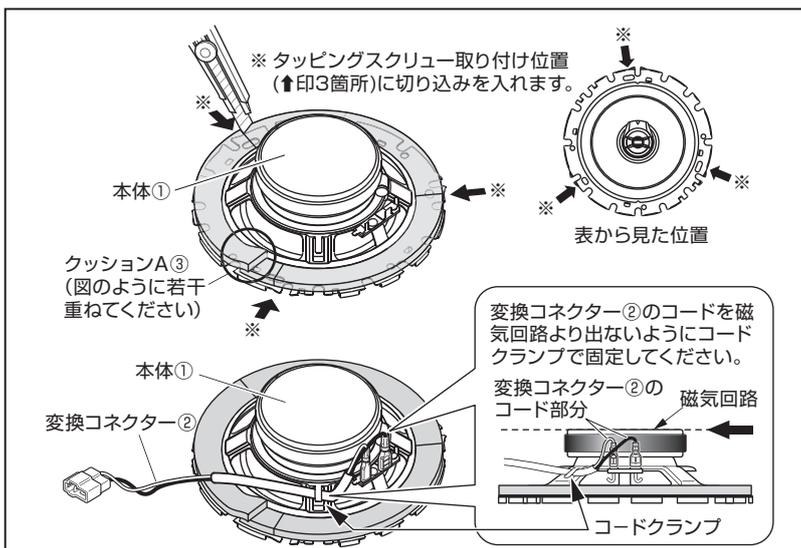
1. 本体①裏の取り付け面にクッションA③を図のように取り付けフランジ部の裏面の内周に沿って貼り付けます。貼りあわせ部は図のように若干重ねてください。
