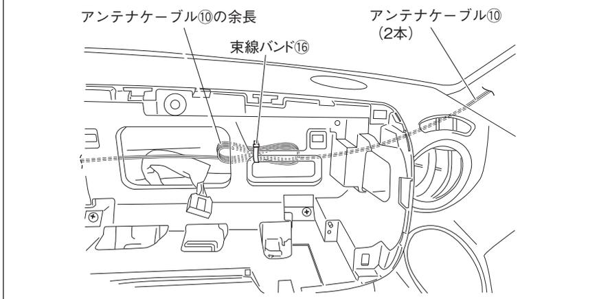
2. アンテナケーブル⑩2本をダッシュボード運転席側からメーター取り付け部奥を通して、ナビゲーション本体①まで配線します。余長は、束線バンド⑯で車両樹脂部に固定します。
