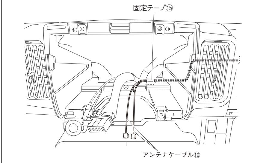
3. アンテナケーブル⑩2本を、固定テープ⑮で車両ハーネスに固定します。
