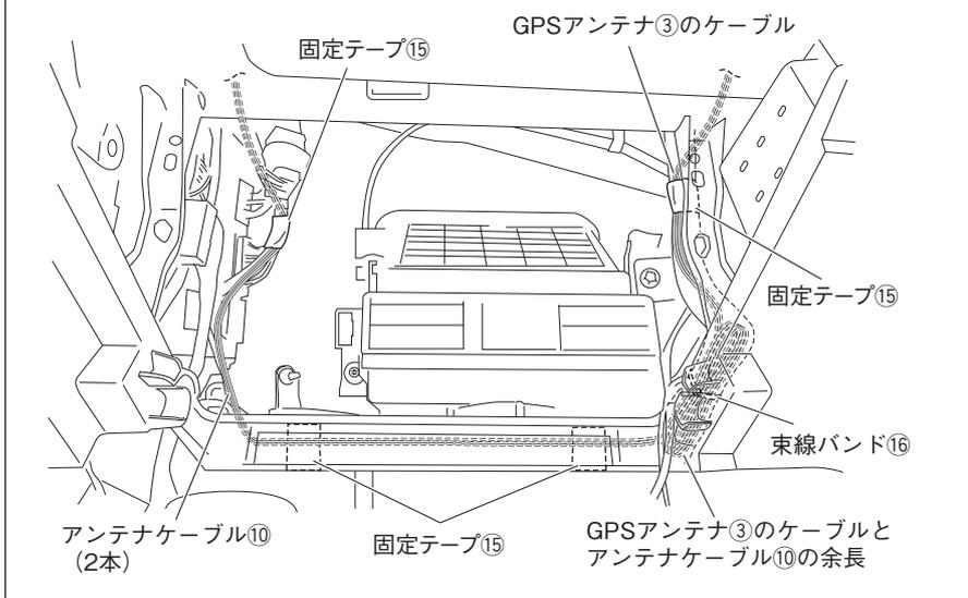
1. GPSアンテナ③のケーブルとアンテナケーブル⑩2本をダッシュボード助手席側からグローブボックス取り付け部奥を通して、ナビゲーション本体①まで配線します。ケーブルは固定テープ⑮で車両ハーネスと車両樹脂部に固定し、余長は束線バンド⑯で車両ハーネスに固定します。
