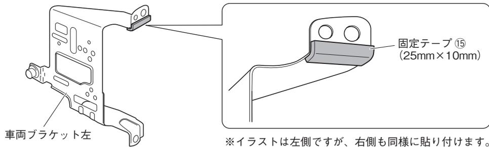
1. 車両ブラケット左右の図の部分に固定テープ⑮ (25mm×10mmにカットしたもの) を貼り付けます。
