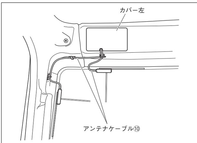
16. 切り欠き加工した部分を通して、カバー左を戻します。
