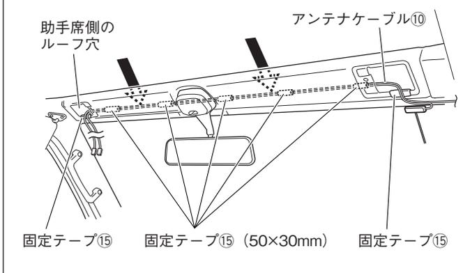
4. アンテナケーブル⑩を固定テープ⑮で巻いて矢印のように車両板金の内側へ配線し、助手席側のルーフ穴から引き出します。
