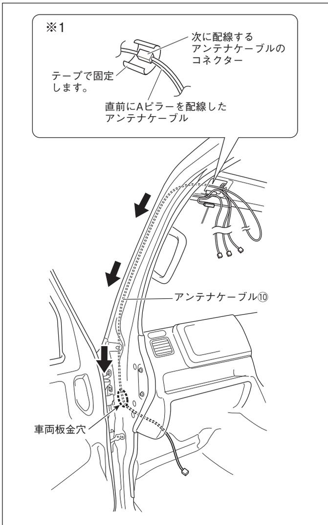
10. アンテナケーブル⑩を助手席側Aピラーの中へ配線して、グローブボックス取り付け部左奥の車両板金穴から引き出します。
