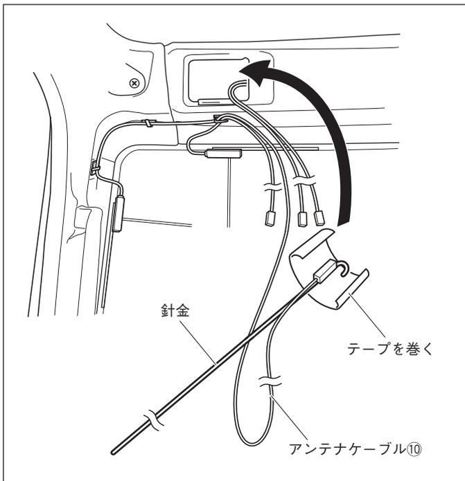
8. 針金などを用意して、先端部分にアンテナケーブル⑩を固定します。
