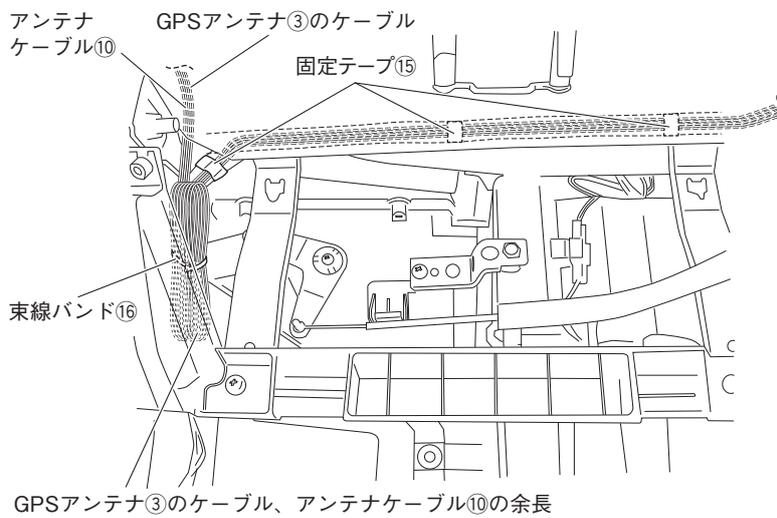
15. GPSアンテナ③のケーブルとアンテナケーブル⑩を、グローブボックス取り付け部奥を通して、ナビゲーション本体①まで配線します。ケーブルは固定テープ⑮で車両ハーネスに固定し、余長は束線バンド⑯で車両ハーネスに固定します。
