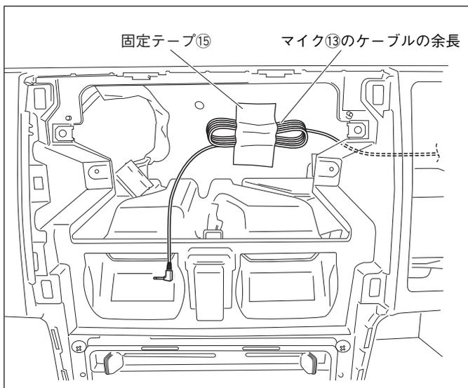
3. マイク⑬のケーブルをナビゲーション本体①まで配線します。余長は固定テープ⑮で車両の樹脂部に固定します。
