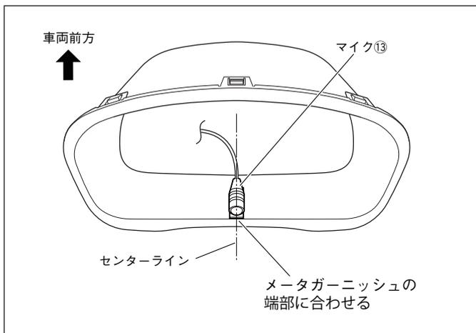
2. メーターを車両に戻した後、マイク⑬をメーターガーニッシュの図の位置に取り付けます。
