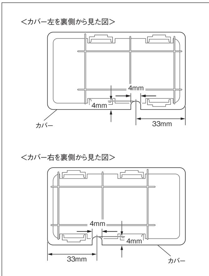
1. 取り外したカバー左右をを、左図の寸法で切り欠き加工します。
