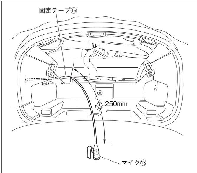
1. マイク⑬のケーブルをメーター取り付け部から250mm引き出し、固定テープ⑮で車両ハーネスに固定します。
