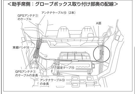
1. GPSアンテナ③のケーブルとアンテナケーブル⑩2本をダッシュボード助手席側からグローブボックス取り付け部奥を通して、ナビゲーション本体①まで配線します。
