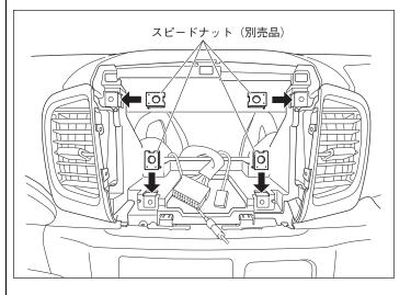
1. ナビゲーション取り付け部の図の位置に、別売品のスピードナット(別売品)を取り付けます。
