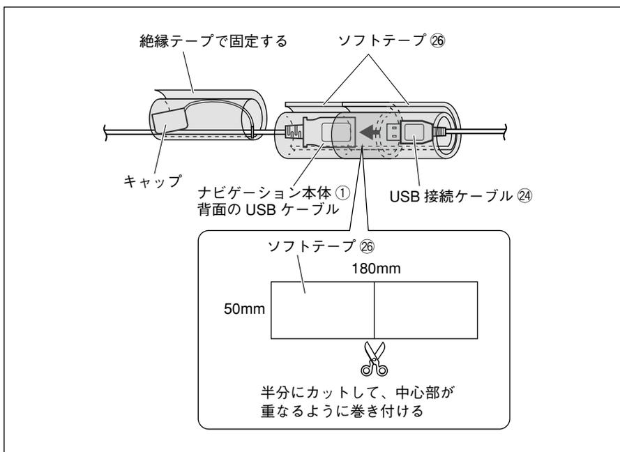
4. ナビゲーション本体①背面のUSBケーブルとUSB接続ケーブル②④を接続します。接続部は、異音と抜け防止のためソフトテープ②⑥を巻きます。取り外したUSBのキャップは、絶縁テープでUSBケーブルに巻いて固定してください。
