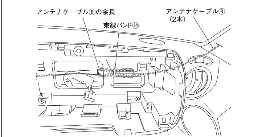
2. アンテナケーブル⑧2本をダッシュボード運転席側からメーター取り付け部奥を通して、ナビゲーション本体①まで配線します。余長は、束線バンド⑭で車両樹脂部に固定します。
