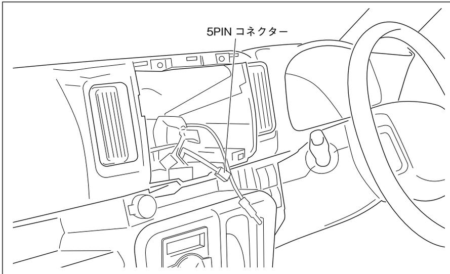
1. 5PINコネクターの線が車両ハーネスにテープで固定されているので、このテープを外します。
