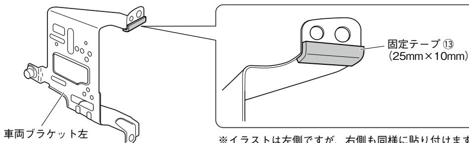
1. 車両ブラケット左右の図の部分に固定テープ⑬ (25mm×10mmにカットしたもの) を貼り付けます。
