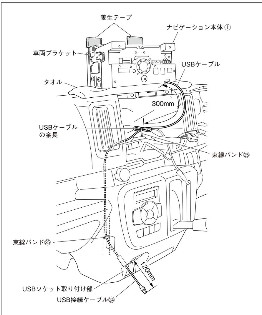
6. ダッシュボードの上をタオルなどで保護し、ナビゲーション本体①を逆さにして置きます。その際、車両ブラケットの図の部分に養生テープを貼ります。
