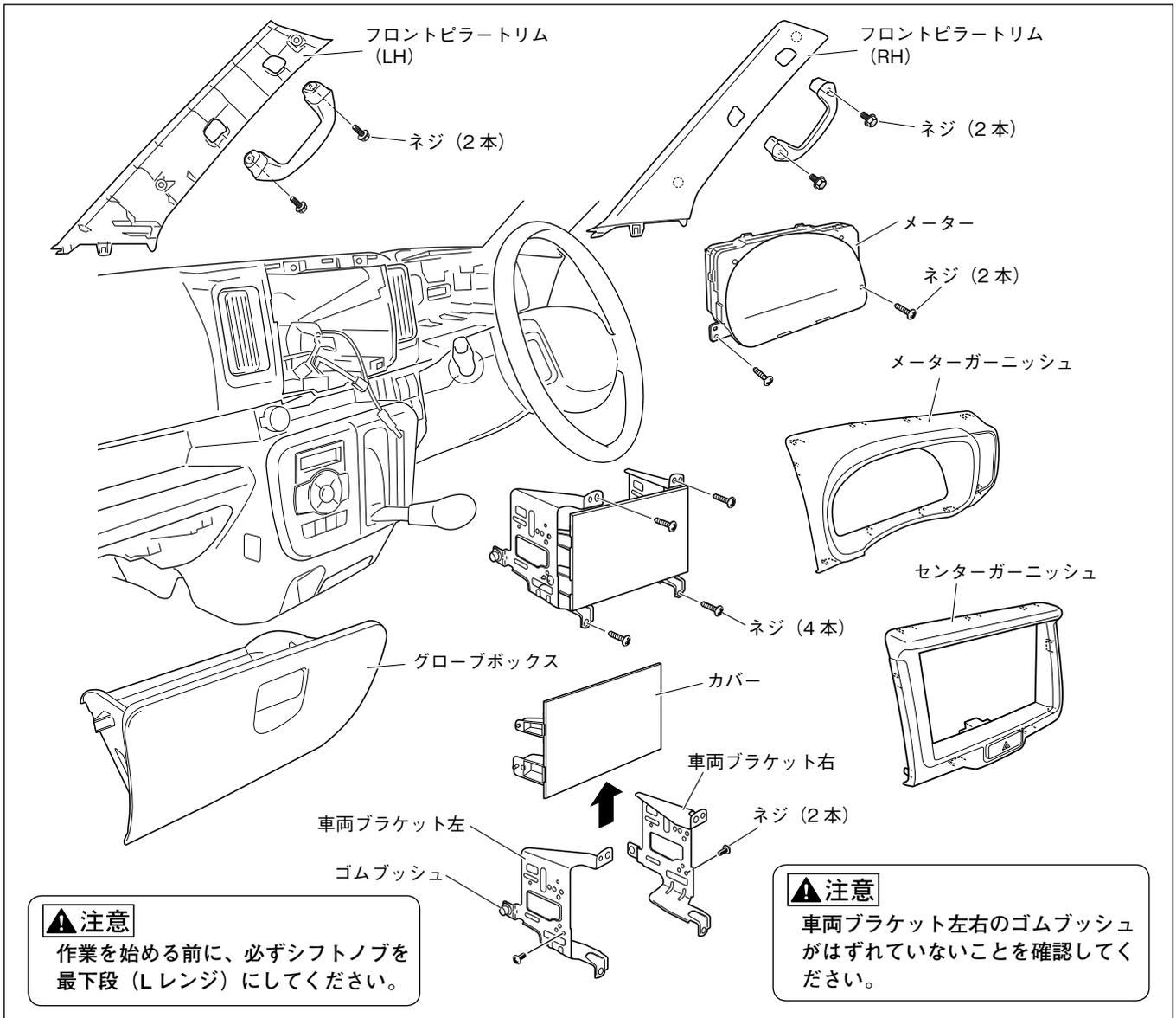
1. アシストグリップを取り外し (ネジ LH/RH各2本)、フロントピラートリム (LH/RH) を取り外します。
