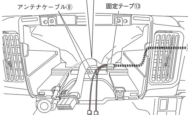
3. アンテナケーブル⑧2本を、固定テープ⑬で車両ハーネスに固定します。
