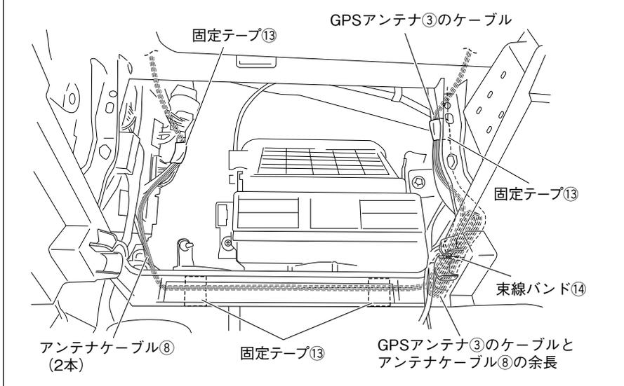
1. GPSアンテナ③のケーブルとアンテナケーブル⑧2本をダッシュボード助手席側からグローブボックス取り付け部奥を通して、ナビゲーション本体①まで配線します。ケーブルは固定テープ⑬で車両ハーネスと車両樹脂部に固定し、余長は束線バンド⑭で車両ハーネスに固定します。
