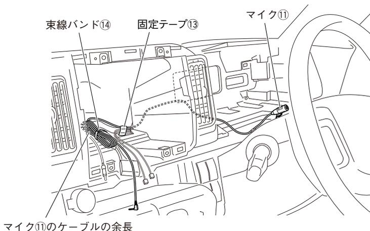
4. 左図のようにマイク⑪のケーブルをナビゲーション本体①まで配線します。ケーブルは固定テープ⑬で車両ハーネスに固定し、余長は束線バンド⑭で車両ハーネスに固定します。
