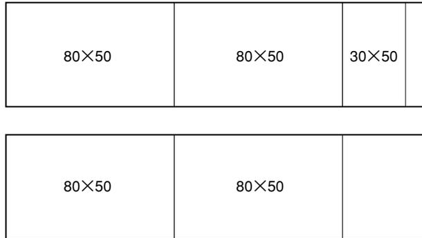
1. 車両側の板金エッジ部を保護するため、保護シート⑬を左図のようにカットします。
