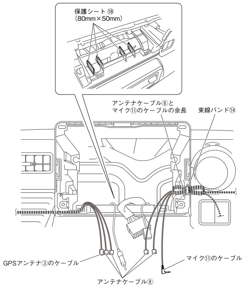
3. 運転席側から配線したアンテナケーブル⑧ 2本とマイク⑪のケーブルの余長を、束線バンド⑭で車両ハーネスに固定します。
