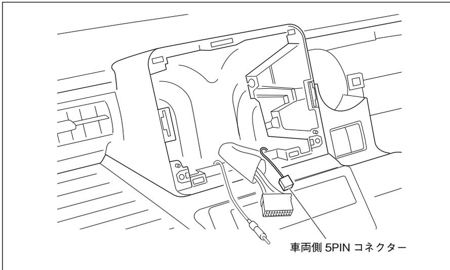
1. 5PINコネクタの線が車両ハーネスにテープで固定されているので、このテープを外します。
