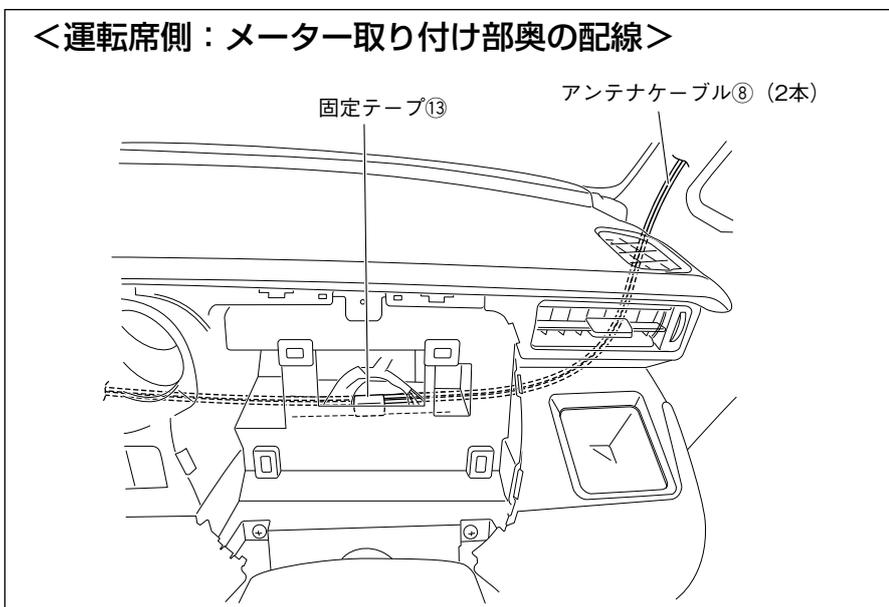
2. アンテナケーブル⑧2本をダッシュボード運転席側からメーター取り付け部奥を通して、ナビゲーション本体①まで配線します。アンテナケーブル⑧2本は固定テープ⑬で車両ハーネスに固定します。
