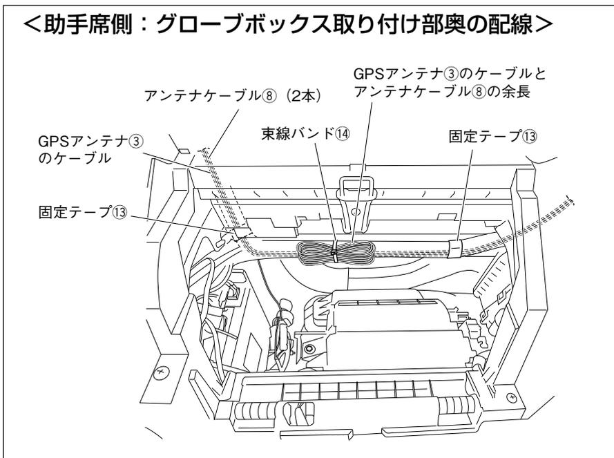
1. GPSアンテナ③のケーブルとアンテナケーブル⑧2本をダッシュボード助手席側からグローブボックス取り付け部奥を通して、ナビゲーション本体①まで配線します。ケーブルは固定テープ⑬で車両ハーネスに固定し、余長は束線バンド⑭で車両ハーネスに固定します。
