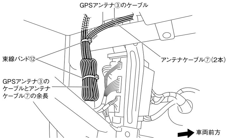
1. GPSアンテナ③のケーブルとアンテナケーブル⑦2本をダッシュボード助手席側からグローブボックス取り付け部奥を通して、ナビゲーション取り付け部まで配線します。ケーブルは束線バンド⑫と固定テープ⑭で車両ハーネスに固定し、余長は束線バンド⑫で車両ハーネスに固定します。
