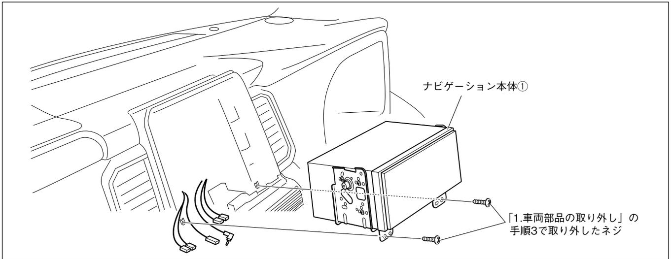
9. 結線図を参照して配線を接続します。
