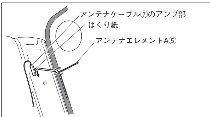
6. アンテナケーブル⑦のアンプ部のはくり紙をはがし、アンテナエレメントA⑤の給電端子にアンテナケーブル⑦のアンプ部を貼り付けます。アンテナケーブル⑦のアンプ部の目印をアンテナエレメントA⑤に合わせて貼り付けてください。
