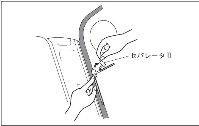
4. アンテナエレメントA⑤を押さえながらセパレータIIをはがし、アンテナエレメントを貼り付けます。
