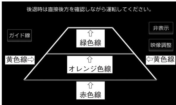
黄色線：ドアミラーを含む車幅
