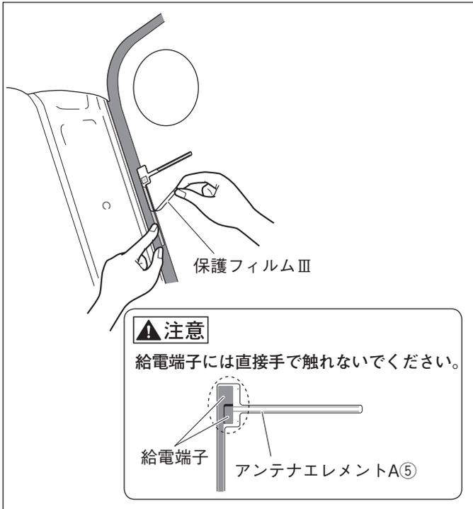
5. 樹脂製のヘラなどでフィルムの上からアンテナエレメントA⑤を十分に密着させて、保護フィルムを静かにはがします。
