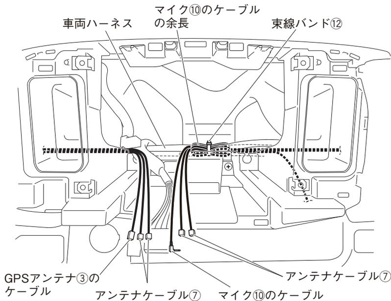
3. 運転席側から配線したマイク⑩のケーブルの余長とアンテナケーブル⑦ (2本)を、束線バンド⑫で車両ハーネスに固定します。
