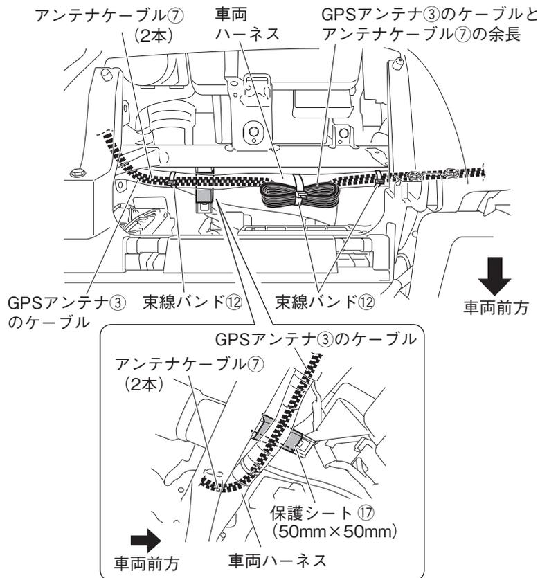
1. GPSアンテナ③のケーブルとアンテナケーブル⑦2本をダッシュボード助手席側からグローブボックス取り付け部奥を通して、ナビゲーション取り付け部まで配線します。ケーブルは束線バンド⑫で車両ハーネスに固定し、余長は束線バンド⑫で車両ハーネスに固定します。
