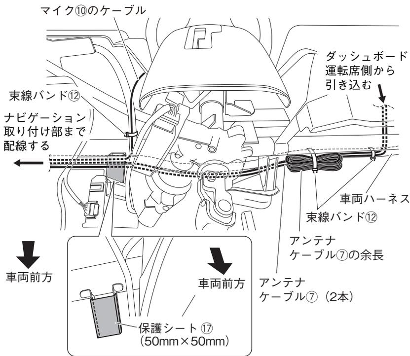
2. アンテナケーブル⑦をダッシュボード運転席側からメーター裏を通して、ナビゲーション取り付け部まで配線します。
