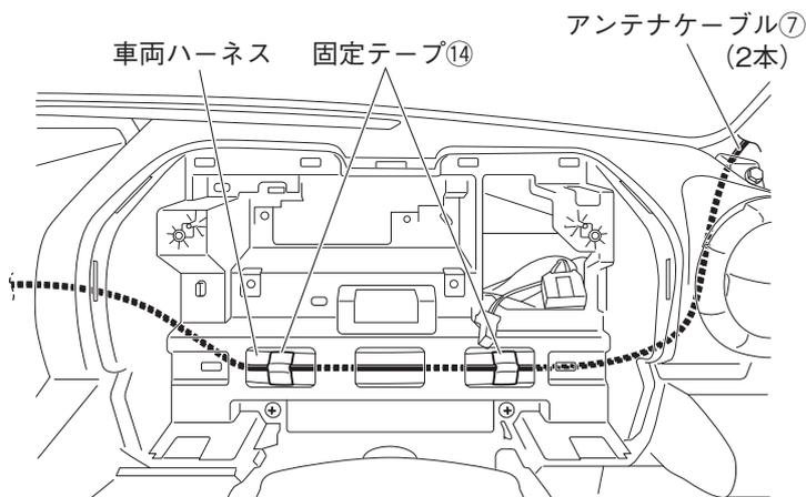
2. アンテナケーブル⑦2本をダッシュボード運転席側からメーター取り付け部奥を通して、ナビゲーション取り付け部まで配線します。ケーブルは固定テープ⑭で車両ハーネスに固定します。
