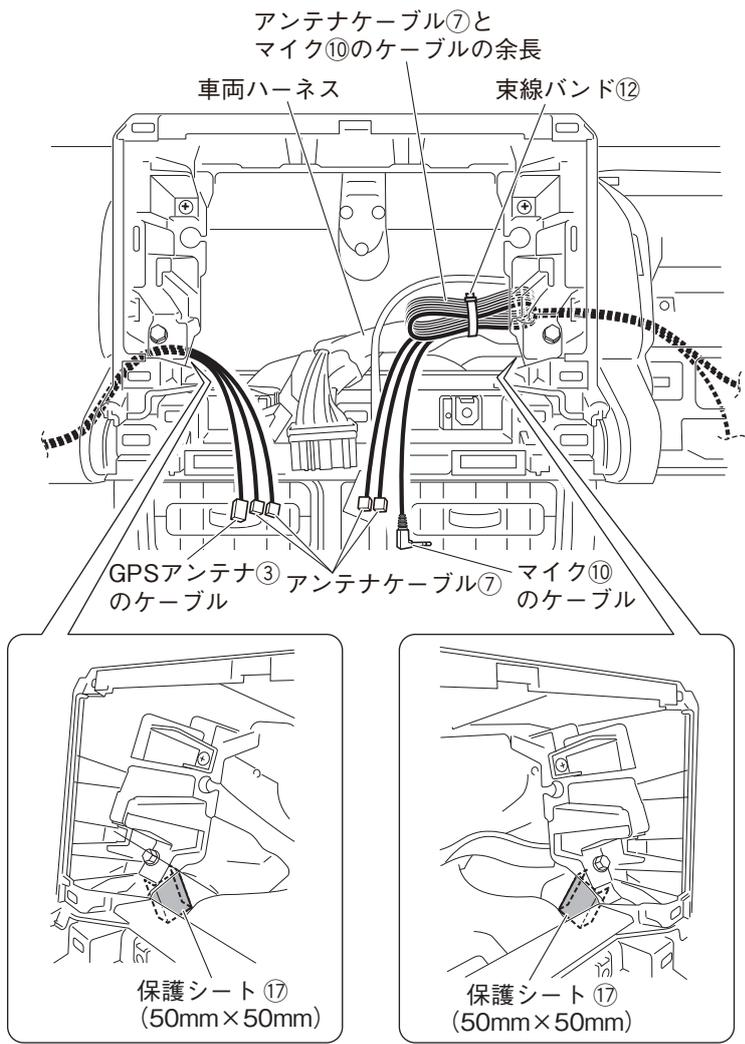
3. 運転席側から配線したアンテナケーブル⑦2本とマイク⑩のケーブルの余長を、束線バンド⑫で車両ハーネスに固定します。
