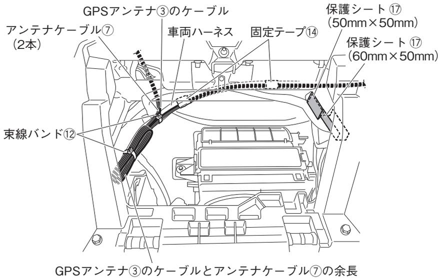
1. GPSアンテナ③のケーブルとアンテナケーブル⑦2本をダッシュボード助手席側からグローブボックス取り付け部奥を通して、ナビゲーション取り付け部まで配線します。ケーブルは固定テープ⑭で車両ハーネスに固定し、余長は束線バンド⑫で車両ハーネスに固定します。
