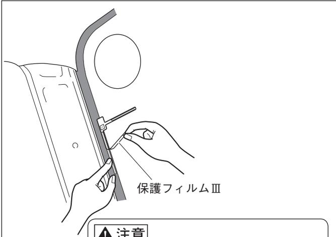
5. 樹脂製のヘラなどでフィルムの上からアンテナエレメントA⑤を十分に密着させて、保護フィルムを静かにはがします。
