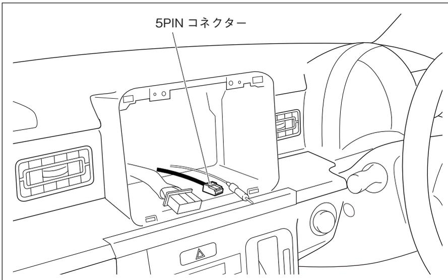
1. 5PINコネクターの線が車両ハーネスにテープで固定されているので、このテープを外します。
