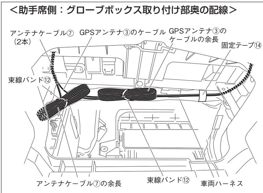
1. GPSアンテナ③のケーブル、アンテナケーブル⑦2本をダッシュボード助手席側からグローブボックス取り付け部奥を通して、ナビゲーション取り付け部まで配線します。ケーブルは固定テープ⑭で車両ハーネスに固定し、余長は束線バンド⑫で車両ハーネスに固定します。
