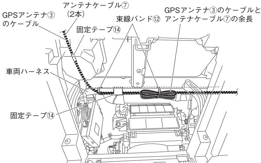
1. GPSアンテナ③のケーブルとアンテナケーブル⑦2本をダッシュボード助手席側からグローブボックス取り付け部奥を通して、ナビゲーション取り付け部まで配線します。ケーブルは固定テープ⑭と束線バンド⑫で車両ハーネスに固定し、余長は束線バンド⑫で車両ハーネスに固定します。
