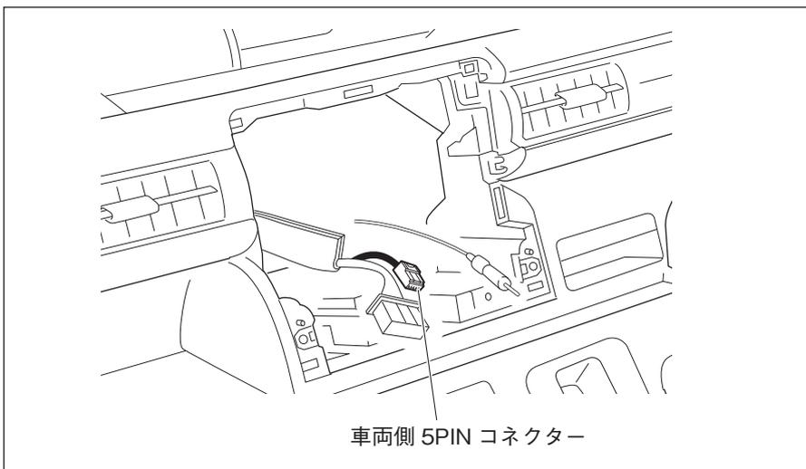
1. 5PINコネクターの線が車両ハーネスにテープで固定されているので、このテープを外します。
