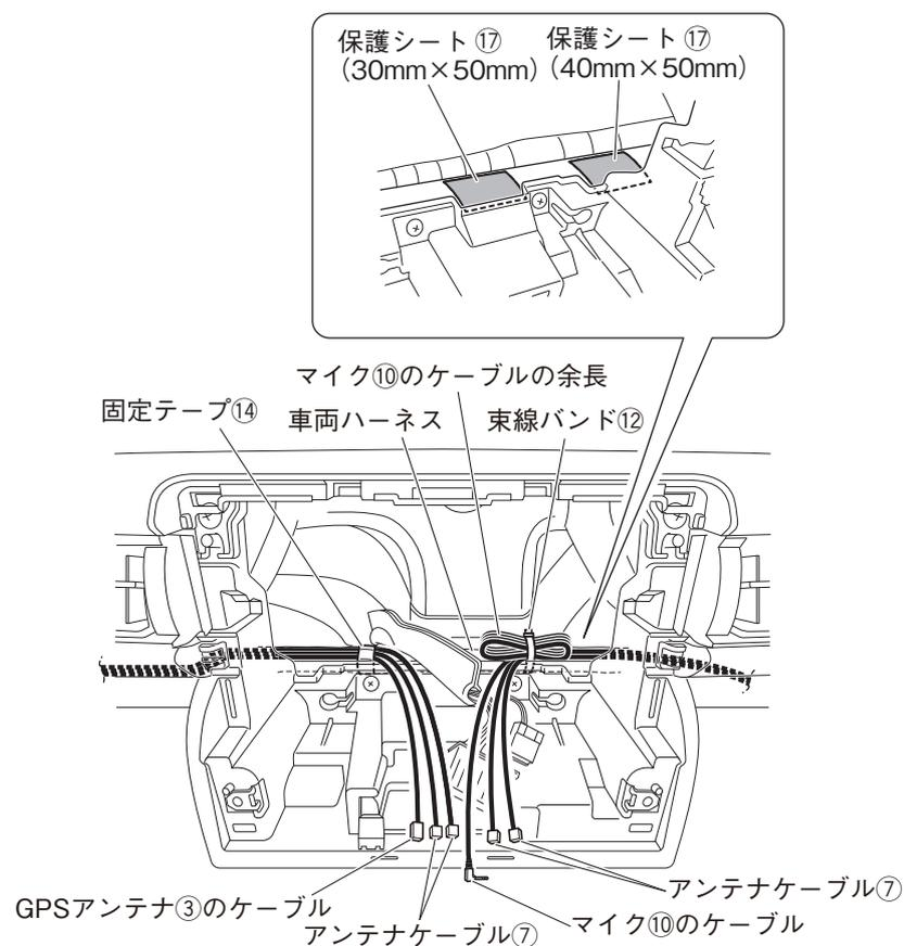
3. 助手席側から配線したアンテナケーブル⑦2本とGPSアンテナ③のケーブルを、固定テープ⑭で車両ハーネスに固定します。
