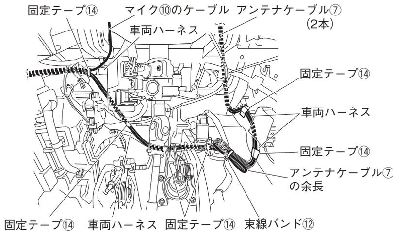
2. アンテナケーブル⑦2本をダッシュボード運転席側からドライブシャフト奥側を通して、ナビゲーション取り付け部まで配線します。また、マイク⑩のケーブルもナビゲーション取り付け部まで配線します。ケーブルは固定テープ⑭で車両ハーネスに固定し、余長は束線バンド⑫で車両ハーネスに固定します。
