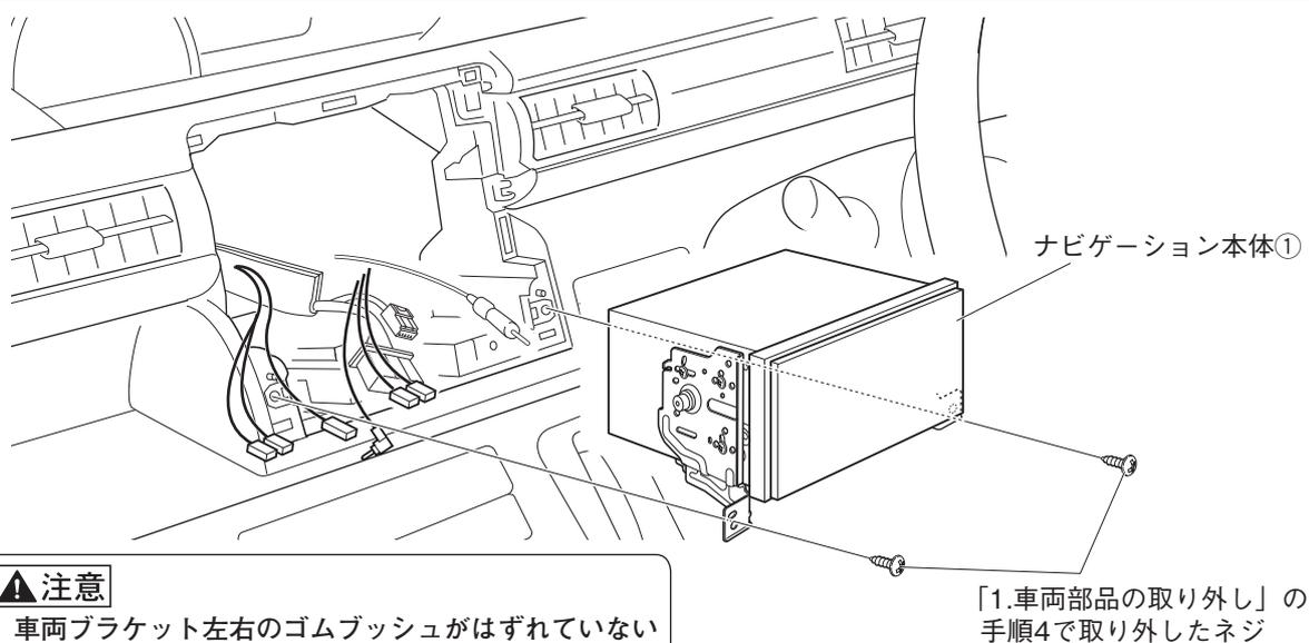
12. 結線図を参照して配線を接続します。
