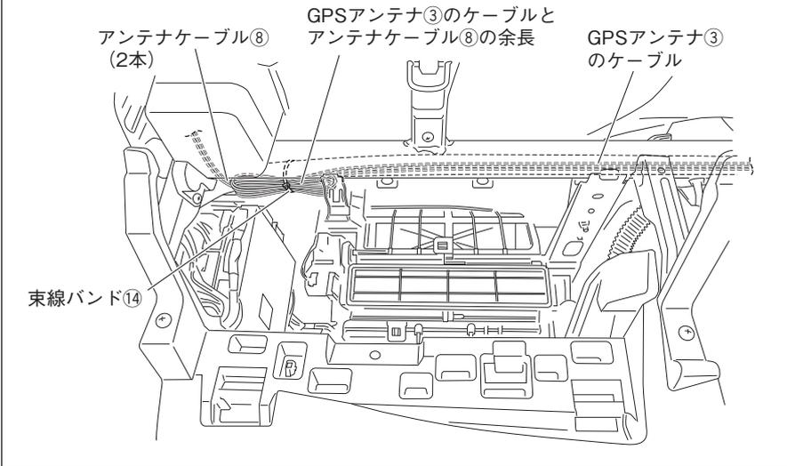
1. GPSアンテナ③のケーブル、アンテナケーブル⑧ (2本) をダッシュボード助手席側からグローブボックス取り付け部奥を通して、ナビゲーション本体①まで配線します。ケーブルの余長は束線バンド⑭で車両ハーネスに固定します。
