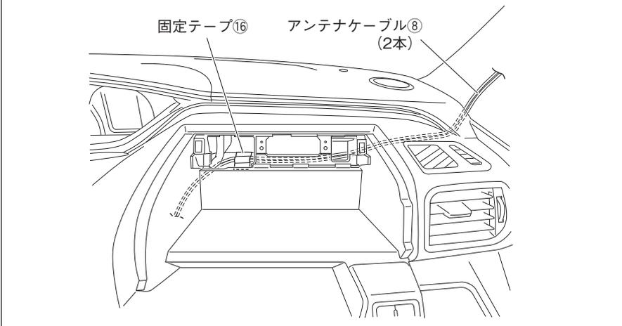
2. アンテナケーブル⑧をダッシュボード運転席側からインパネボックス奥を通して、ナビゲーション本体①まで配線します。アンテナケーブル⑧は固定テープ⑯で車両ハーネスに固定します。
