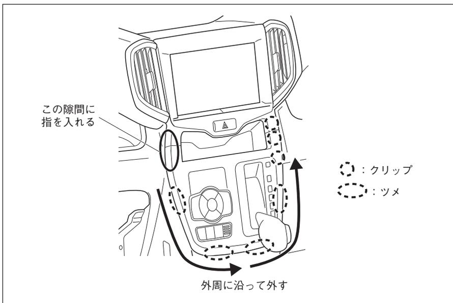
2. クリップが外れた箇所の隙間に指を入れ、シフトパネルの外周に沿ってツメやクリップを取り外します。
