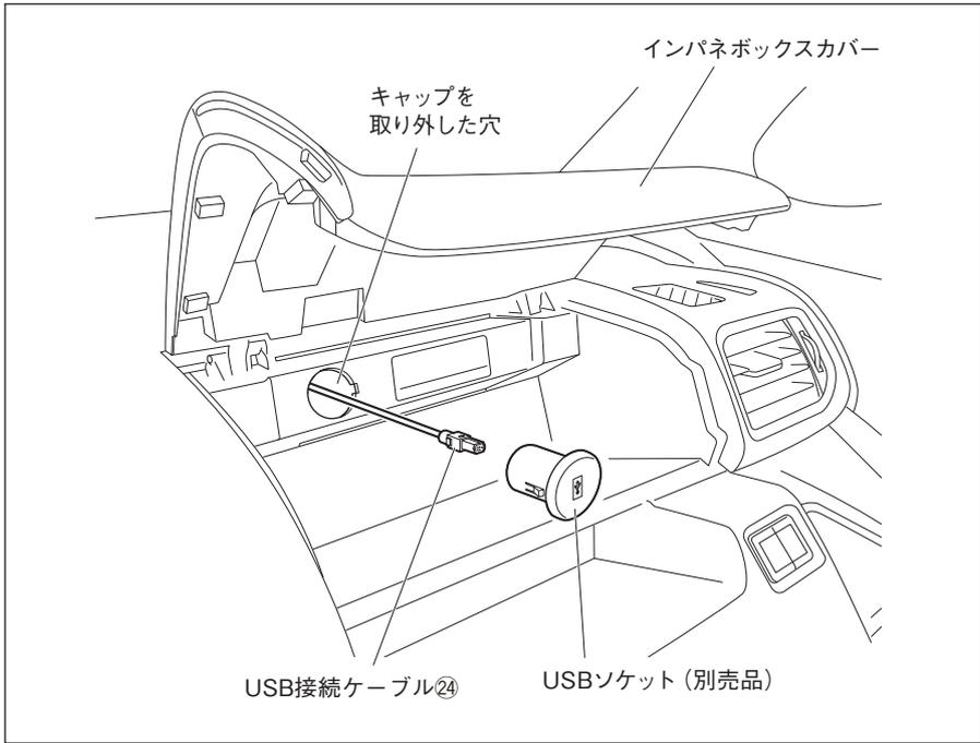
8. インパネボックスカバーからアクセサリソケットのキャップを取り外し、車両に取り付けます。その際、インパネボックスカバーのUSBソケット (別売品) 取り付け部からUSB接続ケーブル㉔を引き出します。
