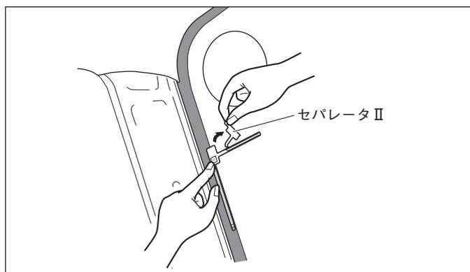
5. 樹脂製のヘラなどでフィルムの上からアンテナエレメントA⑥を十分に密着させて、保護フィルムを静かにはがします。
