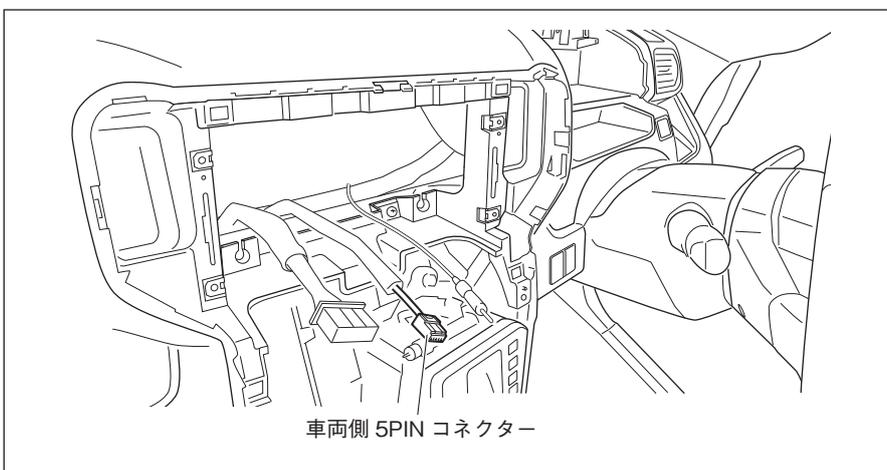
1. 車両側5PINコネクタの線が車両ハーネスにテープで固定されているので、このテープを外します。
