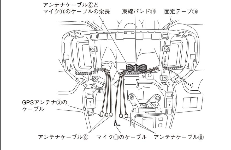
3. 運転席側から配線したアンテナケーブル⑧ (2本) の余長とマイク⑪のケーブルの余長を、束線バンド⑭で車両ハーネスに固定します
