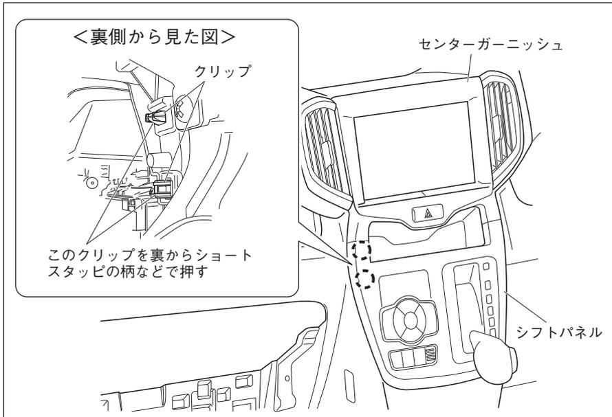
1. グローブボックス取り付け部開口から、シフトパネル裏のクリップ2個を、ショートスタップの柄などで押して取り外します。
