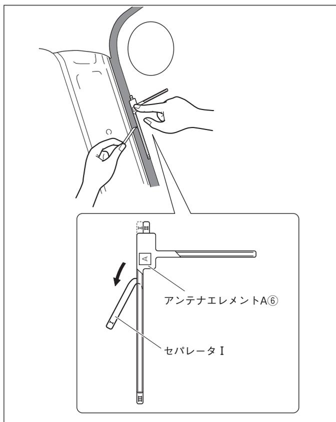
4. アンテナエレメントA⑥を押さえながらセパレータ IIをはがし、アンテナエレメントを貼り付けます。
