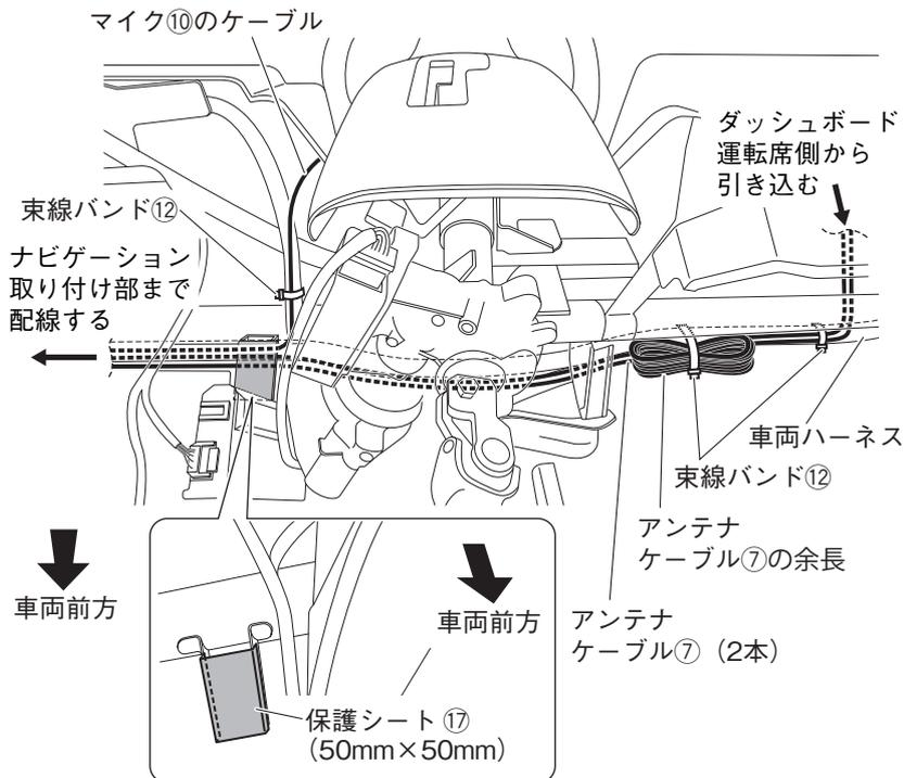
2. アンテナケーブル⑦をダッシュボード運転席側からメーター裏を通して、ナビゲーション取り付け部まで配線します。マイク⑩のケーブルを束線バンド⑫で車両ハーネスに固定しながら、アンテナケーブル⑦と一緒にナビゲーション取り付け部まで配線します。
