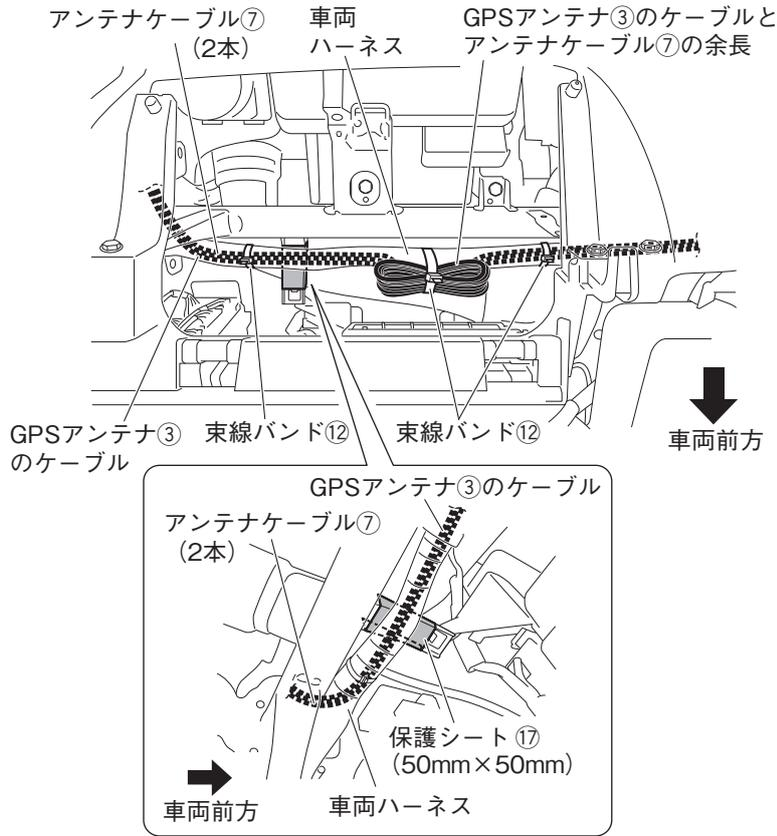
1. GPSアンテナ③のケーブル、アンテナケーブル⑦ (2本) をダッシュボード助手席側からグローブボックス取り付け部奥を通して、ナビゲーション取り付け部まで配線します。ケーブルは束線バンド⑫で車両ハーネスに固定し、余長は束線バンド⑫で車両ハーネスに固定します。
