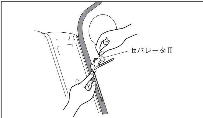
4. アンテナエレメントA⑤を押さえながらセパレータ IIをはがし、アンテナエレメントを貼り付けます。
