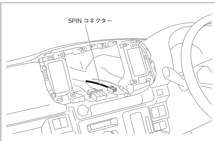
1. 車両側5PINコネクターの線が車両ハーネスにテープで固定されているので、このテープを外します。
