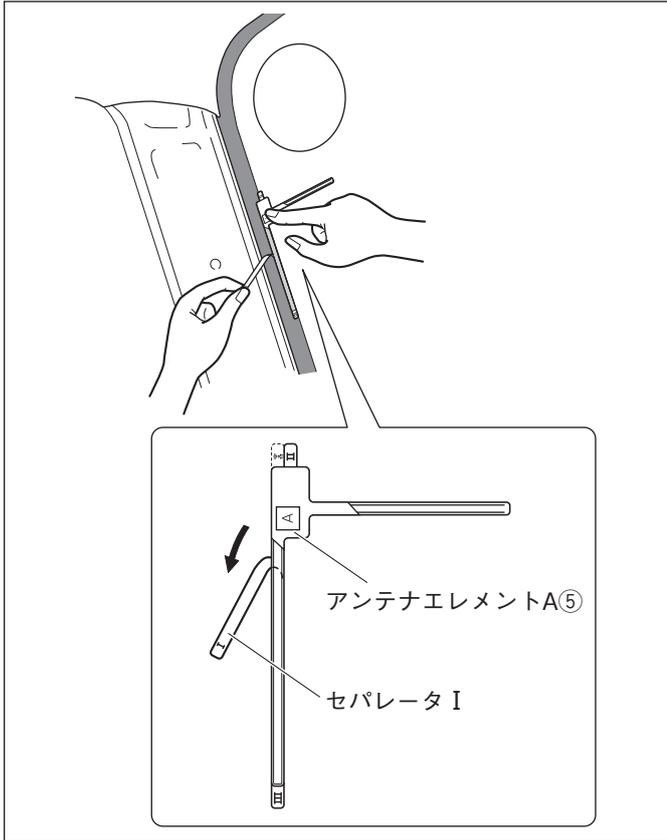
3. アンテナエレメントA⑤を押さえながらセパレータ Iをはがし、アンテナエレメントを貼り付けます。
