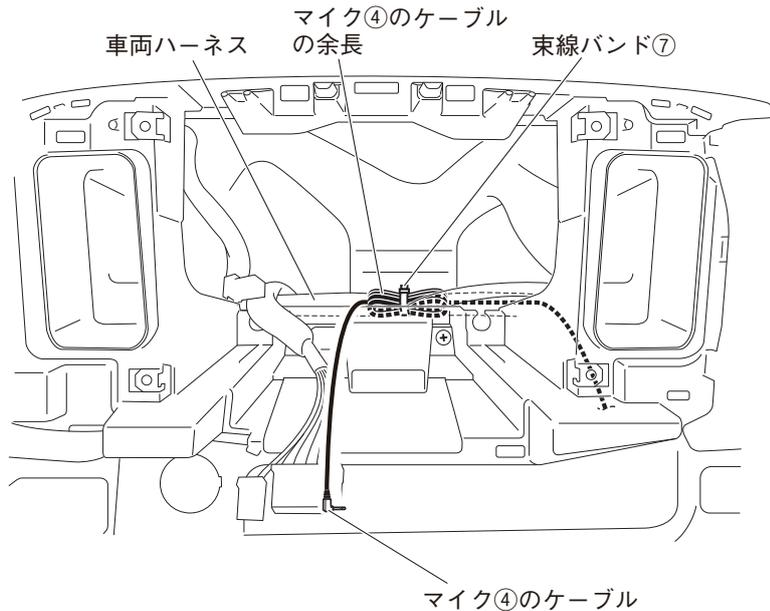
4. 運転席側から配線したマイク④のケーブルの余長を、束線バンド⑦で車両ハーネスに固定します。
