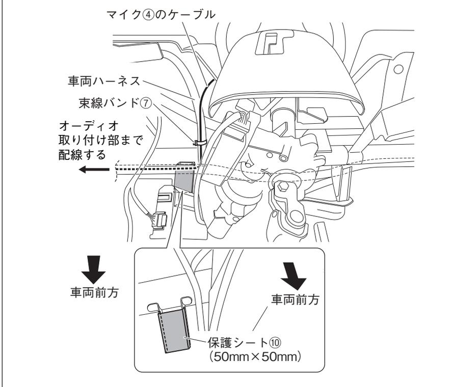
3. マイク④のケーブルを束線バンド⑦で車両ハーネスに固定しながら、オーディオ取り付け部まで配線します。
