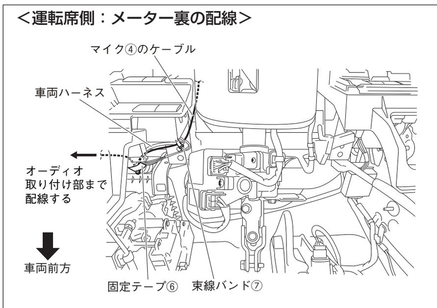
3. マイク④のケーブルを固定テープ⑥と束線バンド⑦で車両ハーネスに固定しながら、オーディオ取り付け部まで配線します。
