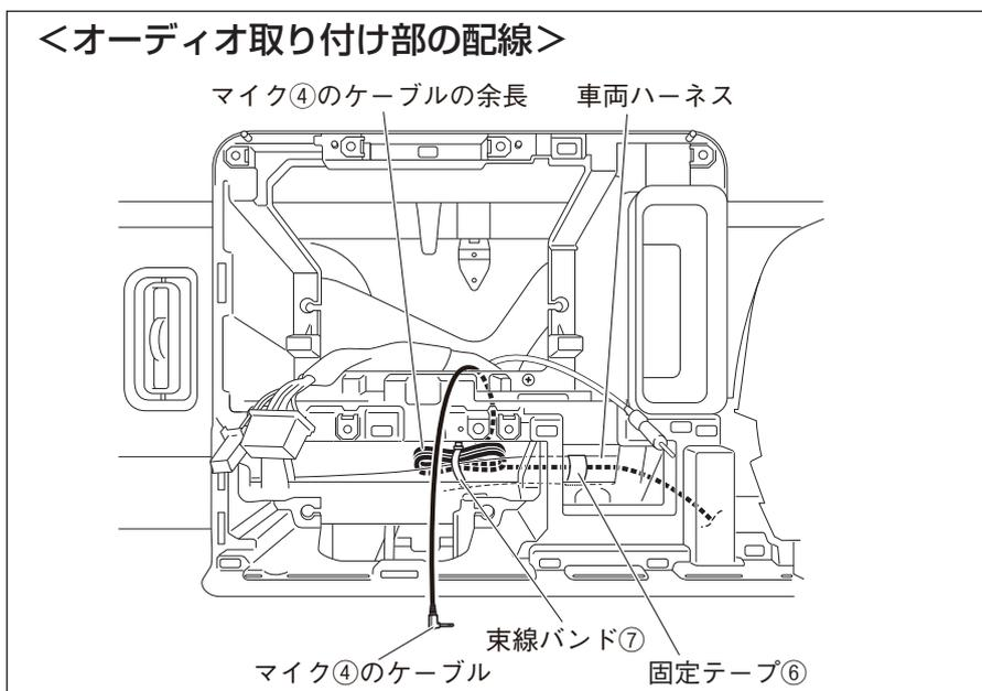
4. 運転席側から配線したマイク④のケーブルを、固定テープ⑥で車両ハーネスに固定します。また余長は束線バンド⑦で車両ハーネスに固定します。
